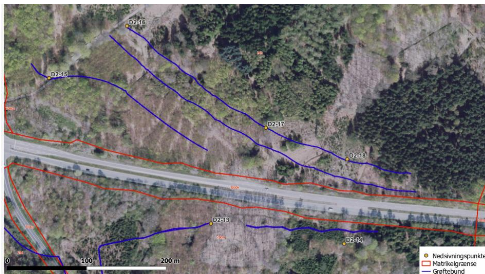
Figur 1 Placering og navngivning af udførte nedsivningstests. De fremtidige grøfter er vist med blå linje.
