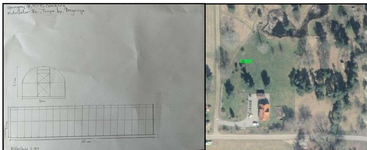
Figur 1: To udsnit af skitser fra ansøgningen som viser drivtunnelens beliggenhed og dimensioner.
